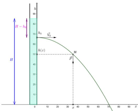
Colonne d'eau ayant une hauteur d'eau  $H$ , percée d'un trou à une hauteur  $h_0$ .
