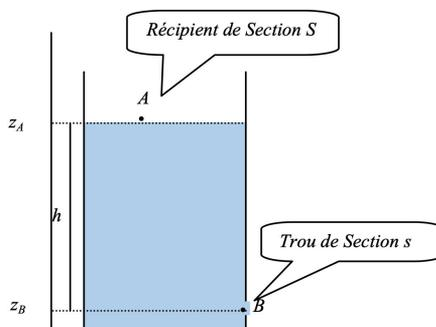
On note  $P_A$  et  $P_B$  les pressions aux points  $A$  et  $B$  respectivement,  $v_A$  et  $v_B$  sont les vitesses respectives d'écoulement du fluide aux points  $A$  et  $B$ ,  $g$  est l'accélération de pesanteur.
