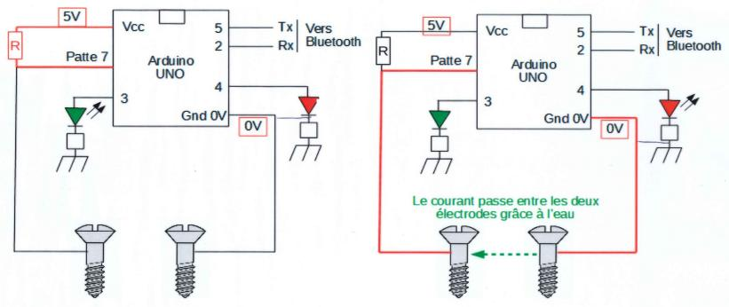
Lorsqu'il n'y a pas d'eau entre les deux capteurs, il y a une tension de 5V sur Patte7.
