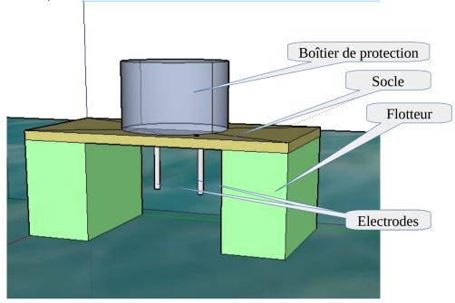
Principe de fonctionnement de la balise :
