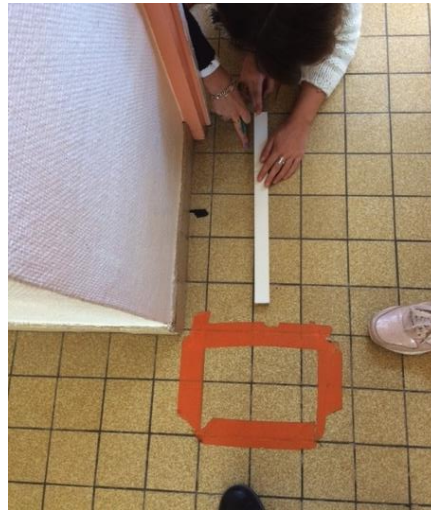
Figure 10. Mesurage de la longueur du parcours en pas de robot à l'aide d'un étalon du pas du robot
