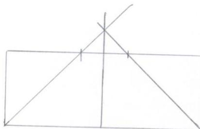
Donc, tracer le contour du gabarit. Sur un grand côté, reporter la longueur du petit côté en partant de chaque sommet et marquer deux points. Joindre chaque point au sommet situé dans le même demi-rectangle. Prolonger ces deux segments jusqu'à intersection. Tracer la perpendiculaire au grand côté du rectangle, passant par le point d'intersection trouvé précédemment. Passant par le point d'intersection trouvé précédemment. C'est terminé. Et bravo. Et nous aussi, bravo !
