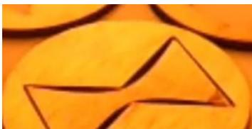
Figure 23. Encastrement erroné réalisé par l'élève dans l'extrait proposé.
