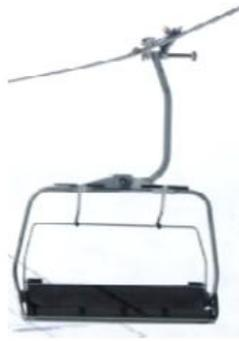
Exemple de véhicule à quatre sièges
