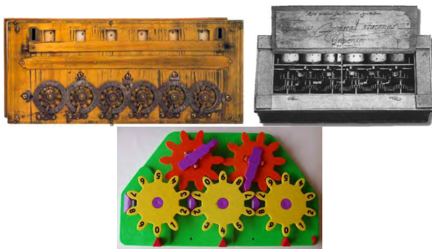
Figure 19. A gauche, la Pascaline de Blaise Pascal, fermée et ouverte pour montrer les engrenages qui la constitue, à droite, la 'pascaline' Zero+1.
