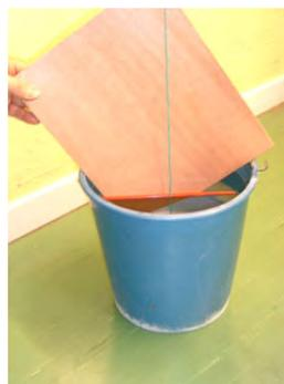
*L'angle droit est matérialisé par le fil se détachant sur un fond uni et une paille posée à la surface de l'eau.*
