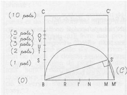
$MM'' = \frac{BM}{10}$  : I' milieu de [BM'']. C demi cercle de diamètre [BM''] coupent [MC'] en S'. D'après les propriétés du triangle rectangle :
