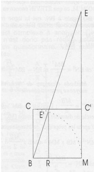
Construire le triangle BME rectangle en M avec  $ME = 3 BM$ . Placer  $E'$  sur  $[BE]$  tel que  $BE' = BM$ . Abaisser la perpendiculaire  $E'R$  sur  $(BM)$
