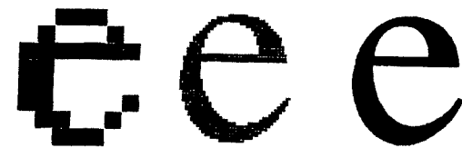
Bitmaps : un même « e » en corps 10, agrandi environ 12 fois dans 3 résolutions différentes 300, 1200, 4800 dpi
