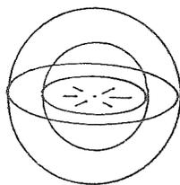
Si l'on veut comparer deux morceaux de surface appartenant à deux sphères concentriques de rayon différent, à quelle condition recevront-ils la même quantité de lumière ? Il suffit que leurs contours appartiennent à un même cône issu de la source lumineuse :
