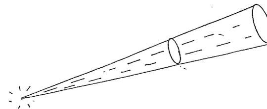
Dans la partie initiale du cône les rayons sont plus serrés, ils sont plus espacés dans la portion plus distante de la source, mais il y en a toujours "autant". Une même quantité de lumière se répartit ainsi sur des surfaces de plus en plus larges, proportionnelles au carré des rayons des sphères concentriques (puisque les surfaces croissent comme le carré des rayons).
