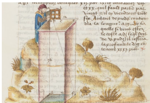
FIGURE 22 – Profondeur d'un puits - Oronce Fine (Fine, 1538, p.14) –
