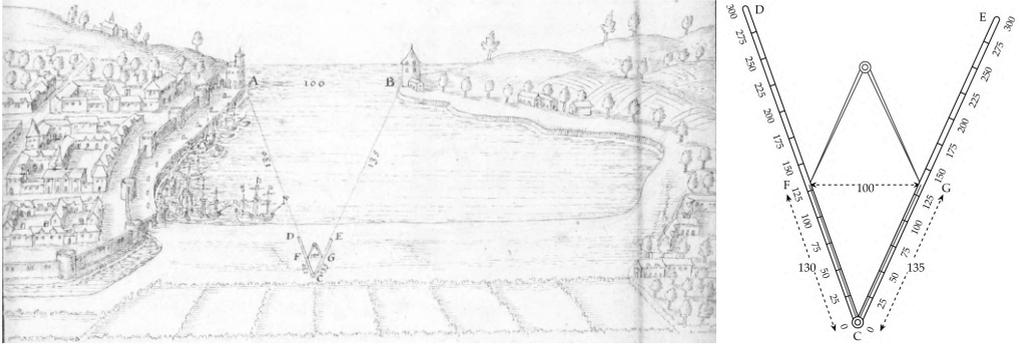
Ill. 22. – L'usage simultané des deux compas pour mesurer des lignes inaccessibles.
