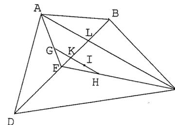
puis GH parallèle à l'autre diagonale AC ; & finalement GI égale à KH ; alors I sera le centre de gravité du quadrangle ABCD
