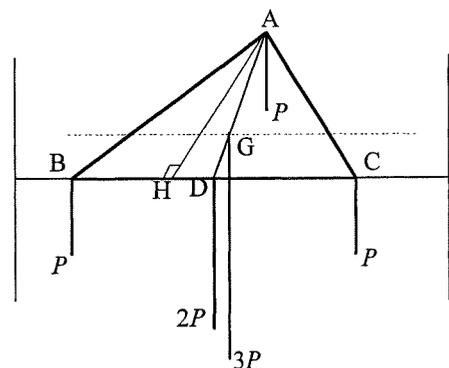
La résultante des deux forces égales et parallèles appliquées en B et C est une force parallèle de grandeur  $P+P=2P$ , appliquée au point D milieu de BC. La résultante de cette résultante et de la force  $P$  appliquée en A est donc une force verticale (un poids) de grandeur  $2P+P=3P$  et appliquée au point G de la médiane tel que :
