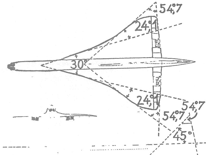
Figure 3 : Vue de dessus du Concorde, couplages angulaires dans E. Angellucci. Encyclopédie des avions Elsevier Sequoia, Bruxelles, 1976.
