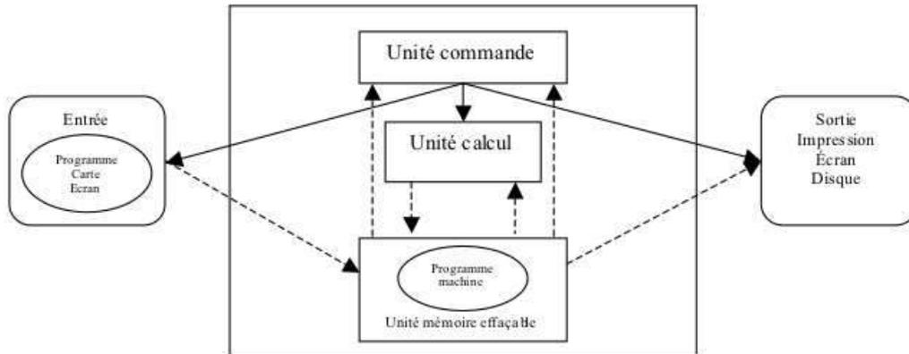
**Figure 3.** Architecture de la machine ordinateur
