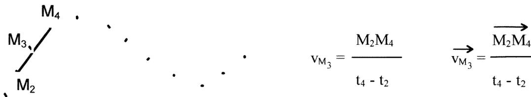
En **Terminale S**, on utilise la notion de dérivée, en cherchant pour la vitesse instantanée, la limite de la vitesse moyenne lorsque l'intervalle de temps tend vers zéro.
