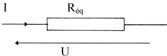
où  $R_{eq}$  est la résistance équivalente, qui se calcule en utilisant la loi d'ohm :
