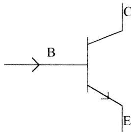
l'intensité du courant entrant par la base est très faible, l'intensité sortant par l'émetteur (dans le cas ici d'un transistor NPN) est nettement plus élevée : un transistor est donc, entre autre, un **amplificateur**.
