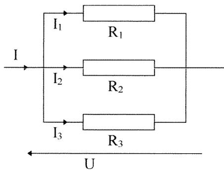
On constate que la tension  $U$  est la même. Un circuit plus simple, électriquement équivalent est :
