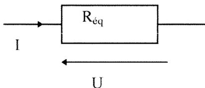
D'après la loi d'additivité des tensions,  $U = U_1 + U_2 + U_3$ , or on a:  $U = R_1 \cdot I + R_2 \cdot I + R_3 \cdot I = R_{eq} \cdot I$ , d'où :  $R_{eq} = R_1 + R_2 + R_3$
