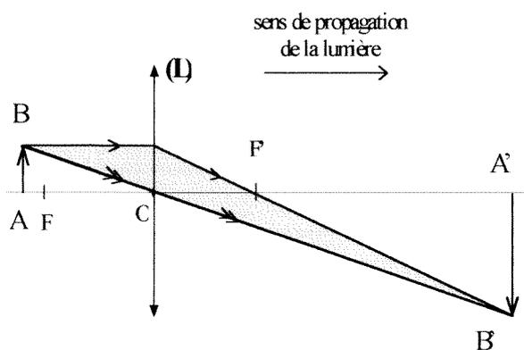
L'image est **réelle** car les rayons lumineux issus de l'objet AB y passent, elle peut donc se matérialiser sur un écran ; on remarquera que  $\overline{OA'} > 0$  ( pour un repère lié à la lentille ).
