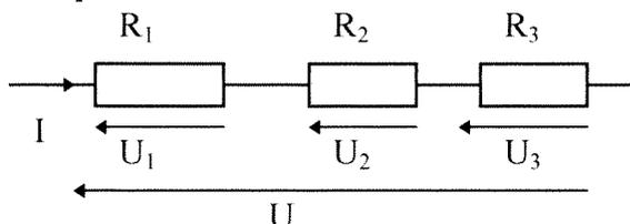
Les trois résistors de résistances  $R_1, R_2, R_3$  sont en série et peuvent être remplacés par un résistor équivalent de résistance  $R_{eq}$  :
