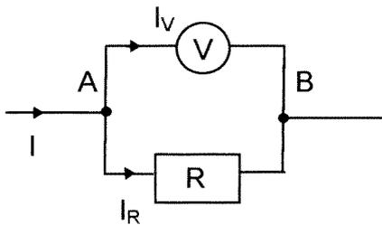
Le voltmètre et le conducteur ohmique sont montés en dérivation entre A et B.
