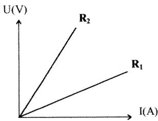
la pente de la droite ( $R_2$ ) est plus importante que celle de ( $R_1$ ) : on peut faire l'analogie avec une pente à gravir. Lors du calcul de cette pente, la résistance du dipôle dans ce cas, on écrira :
