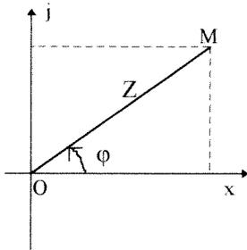
l'axe vertical est l'axe complexe noté  $j$  en physique (et non  $i$  pour ne pas confondre avec  $i$ , l'intensité instantanée).  $OM = Z$ , c'est le module .
