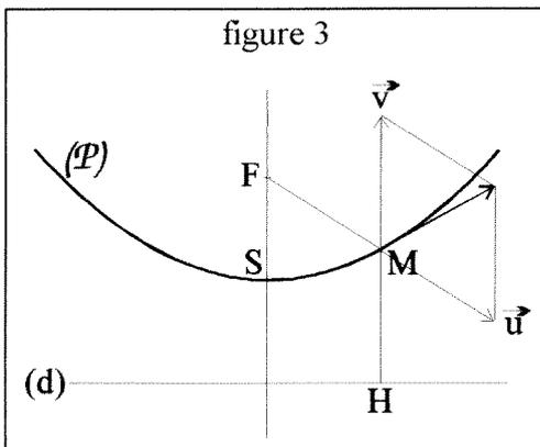
La parabole ( $\mathcal{P}$ ) de foyer F et de directrice (d) est l'ensemble des points M qui vérifient  $MF = MH$  (cf. figure 3) Le mouvement du point M, décrivant la parabole, est composé de deux mouvements représentés par les deux vecteurs  $\vec{u}$  et  $\vec{v}$  de direction FM et HM et de même norme. La direction de la tangente à la parabole ( $\mathcal{P}$ ) en M est donc la direction de la bissectrice de l'angle  $\widehat{FMH}$ .
