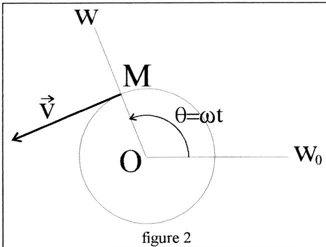
Lorsque le point M est fixe sur une demi-droite [Ow qui pivote autour du point O avec une vitesse angulaire  $\omega$  (exprimée en rad/s), le point M décrit un cercle de centre O et de rayon OM. Le déplacement de M est représenté par le vecteur  $\vec{v}$  qui a pour direction la perpendiculaire à (OM), pour sens, le sens de rotation et pour norme la vitesse linéaire de M (cf. figure 2).
