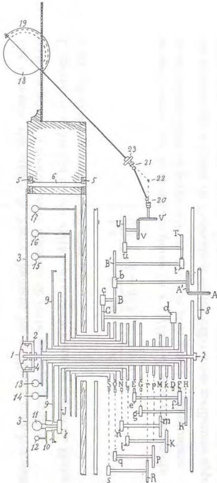
Fig. 49. — Mécanisme du Planétaire et du Globe lunaire.
