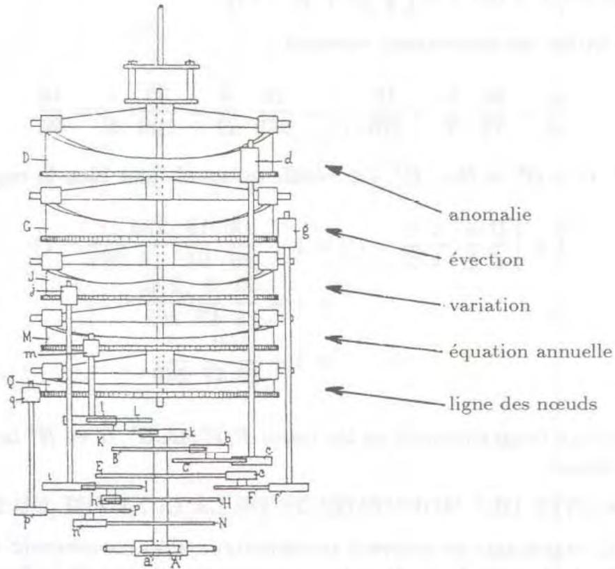
Fig. 12 : Mécanisme des équations lunaires.
