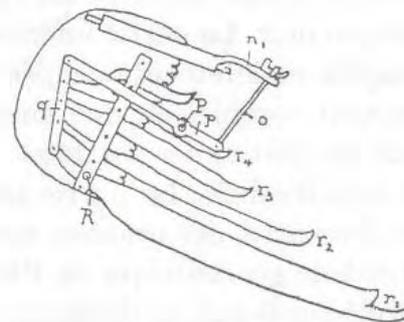
Fig. 4 : Mécanisme des ailes du coq automate.
