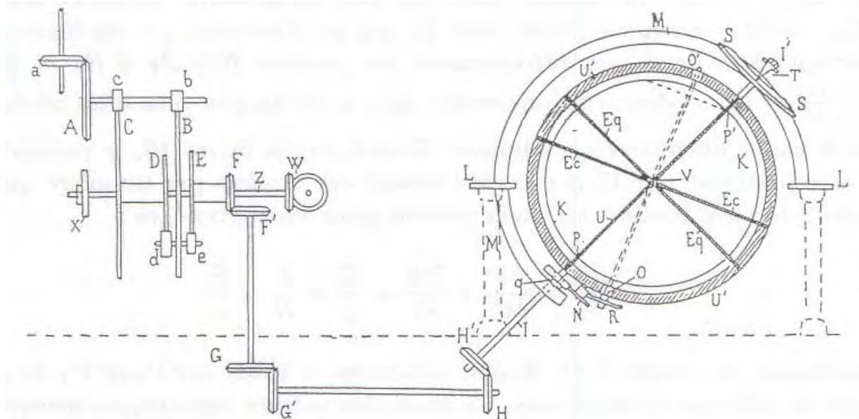
Fig. 11 : Mécanisme du temps sidéral et la Sphère céleste
