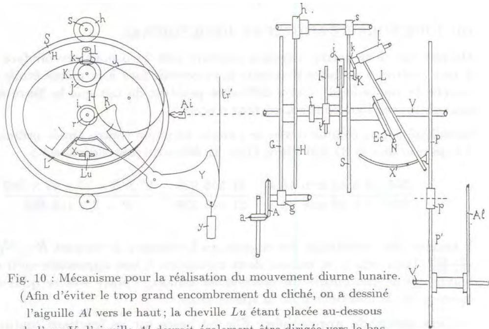
Fig. 10 : Mécanisme pour la réalisation du mouvement diurne lunaire. (Afin d'éviter le trop grand encombrement du cliché, on a dessiné l'aiguille  $Al$  vers le haut; la cheville  $Lu$  étant placée au-dessous de l'axe  $V$ , l'aiguille  $Al$  devrait également être dirigée vers le bas.
