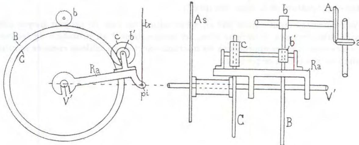
Fig. 14 : Mécanisme pour la réalisation du temps vrai.
