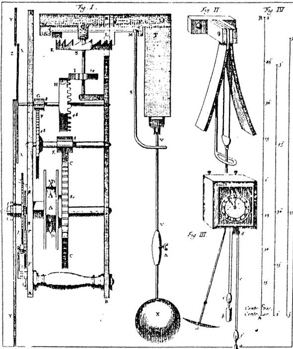
Diagramme extrait de *Horologium oscillatorium* d'Huygens (1673). La figure ci-dessus illustre les mâchoires cycloïdales qui entraînent l'oscillation du pendule selon un arc cycloïdal.
