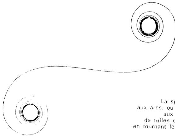
La spirale de Cornu, ou radioïde aux arcs, ou clothoïde permet, appliquée aux travaux publics de négocier de telles courbes à vitesse constante en tournant le volant à vitesse constante.
