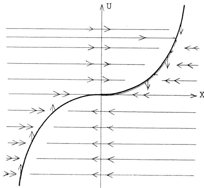
3. Convergence lorsque  $\epsilon \rightarrow 0$  et stabilité du cycle limite de l'équation de Van der Pol avec paramètre.
