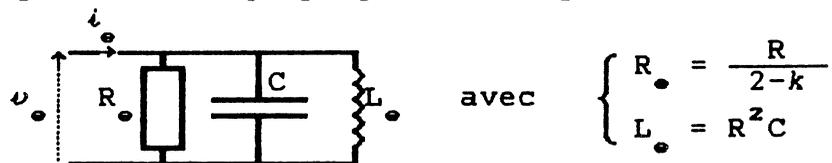
Ainsi, grâce à un tel circuit et en faisant varier  $k$ , on peut passer continûment d'une résistance positive à une résistance négative, soit un passage continu du fonctionnement en résonateur à celui en oscillateur.
