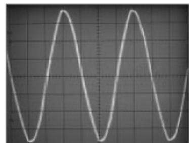
Doc 6 Visualisation à l'oscilloscope de la tension aux bornes du générateur.
