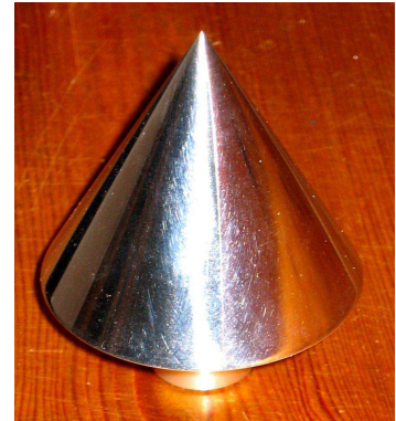
fig.27 : ... pièce après usinage : cône en aluminium poli
