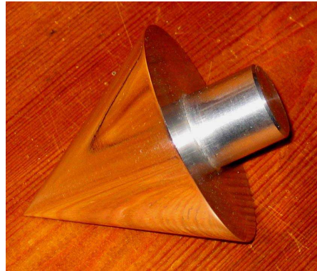
fig.27 : ... pièce après usinage : cône en aluminium poli
