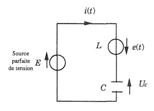
L'inductance pure est traversée par un courant i(t) il apparaît donc e(t); le sens des flèches correspond aux conventions prises par rapport à la notion de générateur et de récepteur. La loi des mailles donne :
