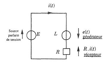
R est traversé par le courant i(t). Aux bornes d'un récepteur, par convention, la tension est en sens inverse du courant d'où les flèches du schéma ci-contre.
