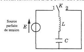
On étudie de la même façon la réponse du circuit (L,C) à une excitation en tention, pour les deux positions de l'interrupteur K.
