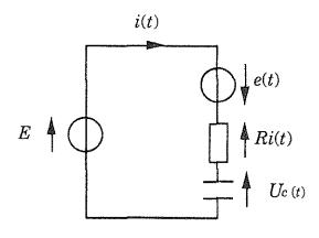
Le condensateur se charge : c'est un récepteur. Un courant passe dans l'inductance, il se crée un f.e.m. d'après la loi des mailles on a :
