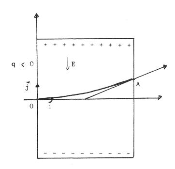
La trajectoire de O à A est parabolique. Au delà elle est rectiligne puisque après A le champ  $\overrightarrow{E}$  est nul, donc  $\overrightarrow{F} = \overrightarrow{O}$ . La particule prend alors la direction de la tangente en A à la parabole. Du fait de l'importance de la vitesse  $\overrightarrow{V}_A$  de la particule et de la faible distance parcourue, le temps de vol de l'électron est de l'ordre de quelques millisecondes.
