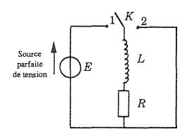
Ce circuit contient une RESISTANCE et une INDUCTANCE PURE (r = 0).
