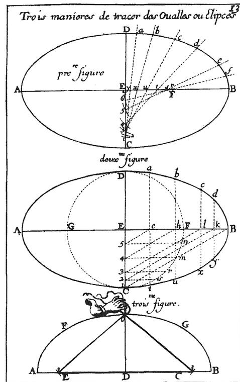
III.2-Construction d'une voûte surbaissée, dite *anse de panier*, solution à la règle et au compas
