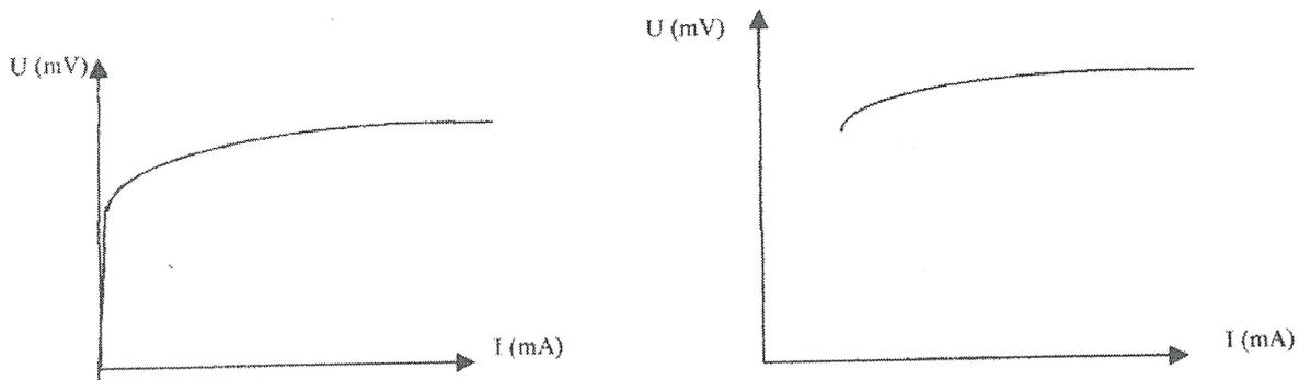
L'expérience a lieu si la tension imposée à l'électrolyseur est au minimum égale à la différence de potentiel des couples redox mis en jeu (les élèves ont vu cette notion en chimie).
