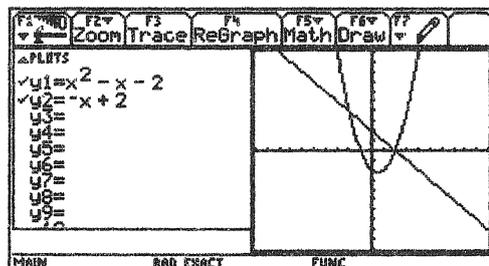
*Tracé de la parabole (C) et de la droite (d<sub>-1</sub>)*
