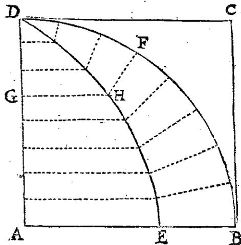
cercle, ayant son centre à l'angle A du Quarré. Faites mouvoir par perpendiculaire le demi-diametre AD, depuis D vers B, à l'entour du centre A, d'un mouvement uniforme par tous les points de la circonference BD, & faites aussi mouvoir en même tems le côté CD, depuis C vers B, par un mouvement aussi uniforme, & parallelement à son côté opposé AB, en sorte qu'en autant de parties égales que l'arc BFD sera divisé par le rayon AD,
