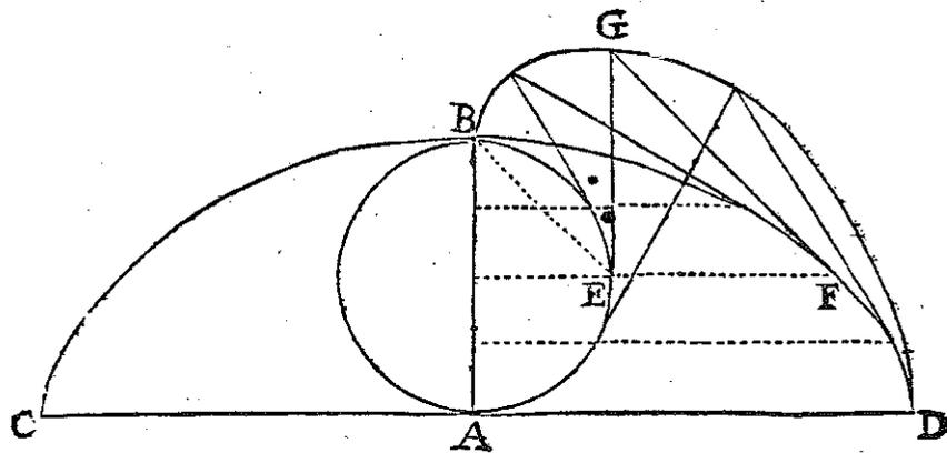
2. Si par le point F pris à discretion sur la cycloïde on tire parallèlement à la base CD, la droite EF terminée en E par la circonférence du cercle generateur, cette ligne EF sera égale à l'arc correspondant EB, du même cercle generateur.
