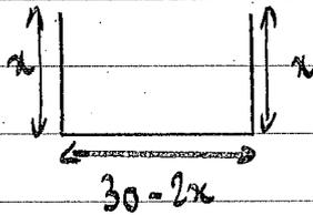
On ne connaît pas exactement la longueur de la gouttière. Intéressons-nous alors à l'aire de l'eau lorsqu'on coupe la gouttière transversalement.
