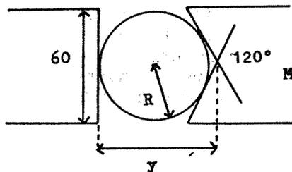
La figure représente un dispositif d'ablocage d'un cylindre par un mors (M).
