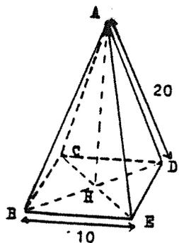
Voici un dessin en perspective cavalière d'une pyramide régulière à base carrée de côté 10. L'arête latérale mesure 20.
