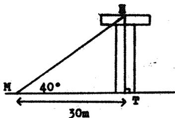
On s'est placé à 30 m d'un château d'eau HT que l'on voit sous un angle de  $40^\circ$ .
