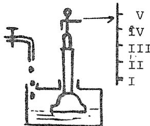
LES HORLOGES MECANIQUES : l'appareil moteur est dû au mouvement d'une masse entraînant un cylindre. Il fallut des siècles de tâtonnement et de recherches pour assurer au cylindre un mouvement régulier, le cylindre commande la rotation d'une aiguille ; celle des heures.
