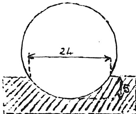
\* Fig. 1 : Calcule le diamètre de la fraise nécessaire pour creuser la pièce hachurée. Les côtes ont en mm.
