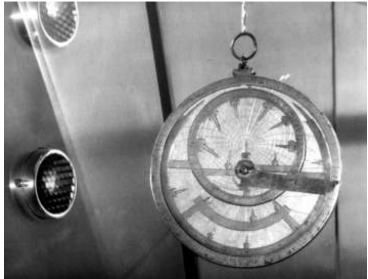
Vue de face : sur la matrice repose un tympan, surmonté de l' araignée mobile et d'un index .
