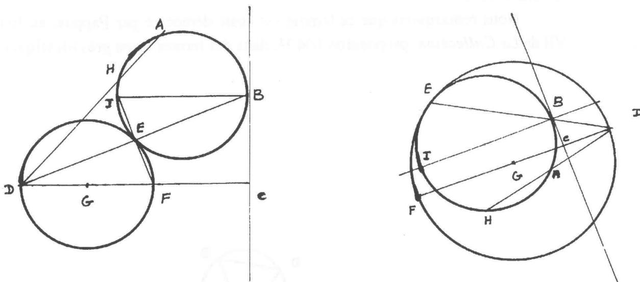
A est le point donné ; G est le centre du cercle donné. De G on abaisse la perpendiculaire sur la droite donnée en C. La droite GC obtenue coupe le cercle de centre G en D et F. Par ailleurs, sur la droite DA est construit H tel que
