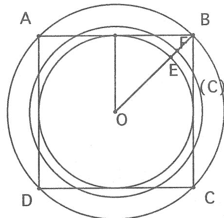
Fig. I-8 : Transformation du carré ABCD en un cercle (C) de même aire et de rayon  $OF = OE + EB/3$
