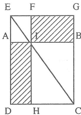
Fig. I-7 : Transformation d'un carré ABCD en un rectangle CHFG de même aire.
