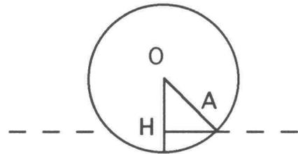
1) Montrer que le diamètre de l'empreinte  $d$ , sa profondeur  $h$  et le diamètre de la bille  $D$  sont liés par la relation:  $h^2 - Dh + \frac{d^2}{4} = 0$ .
