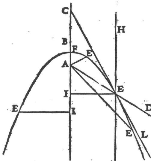
Cela posé si l'on demande la touchante de la Parabole au point  $E$ , soit tiré la ligne  $AE$  prolongée comme en  $D$ , & la ligne  $EI$  perpendiculaire à  $AB$ , & encore la ligne  $HE$  parallèle à l'axe  $FAI$ , alors il est clair par la description ci-dessus, que le mouvement du point
