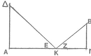
égal à l'angle E. Menons les perpendiculaires BΓ, ΔA sur le miroir. Dès lors, la droite ΔA est à la droite AK comme la droite BΓ est à la droite ΓK; car cela a été supposé dans les définitions. En conséquence, le triangle BΓK est semblable au triangle ΔAK; donc, l'angle E est égal à l'angle Z; car les triangles semblables sont équiangles.
