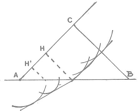
Le même raisonnement fait lorsque C parvient en B donne pour "image" de l'onde plane AC, l'onde plane BT. Mais le rayon lumineux est la direction de propagation de l'onde, il est donc initialement orthogonal à AC et finalement à BT. Or  $\sin i = \sin (B A C)$  et  $\sin r = \sin (A B T)$ , et, avec l'hypothèse,  $3 AT = 2 BC$  donc  $\sin i = 1,5 \sin r$ .
