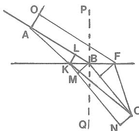
AO perpendiculaire sur AB, FO parallèle à AB ; BH perpendiculaire sur FO, et FG sur BC.
