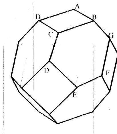
2°) En joignant deux à deux les extrémités de ces carrés on peut alors réaliser un polyèdre à quatorze faces dont six carrées et huit hexagonales.
