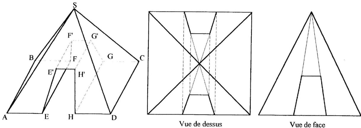
Le volume extérieur SABCD est une pyramide à base carrée de côté  $a$  et de hauteur  $a$ . On a percé à l'intérieur un tunnel de section trapézoïdale de hauteur  $h$  ( $h < a$ ) en respectant les alignements SEE', SFF', SGG', SHH'. La largeur de la base du tunnel est donnée par  $EH = FG = \frac{a}{3}$ .
