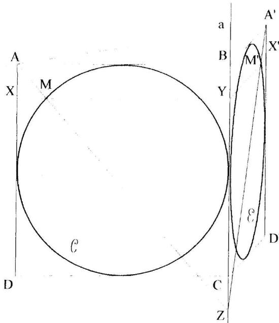
**Point de vue spatial:** Dans la rotation autour de BD qui amène A en A', l'image de AZ est A'Z et l'image de XY est X'Y. Ainsi le point M a pour image l'intersection M' de A'Z et X'Y.
