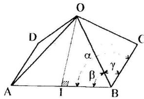
L'angle dièdre du dodécaèdre rhombique est donc l'angle dièdre formé par deux des faces latérales d'une de ces pyramides.
