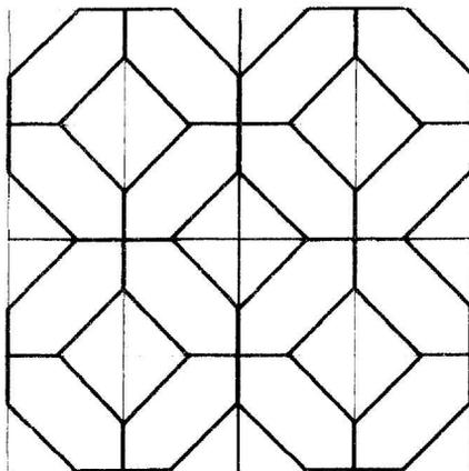
**Partie I:** On réalise un pavage dont les motifs font apparaître octogones réguliers et carrés ( une partie est présentée ci-contre). Les éléments de base sont des carrés 20x20 cm présentant deux axes de symétrie suivant leurs diagonales.
