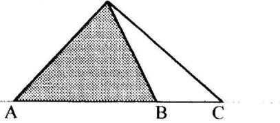
$A, B, C$  étant alignés, les surfaces des triangles  $ABS$  et  $BCS$  sont dans le rapport de leurs bases  $AB$  et  $BC$ .
