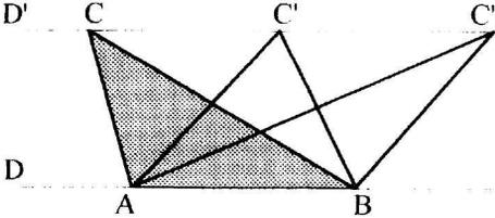
Si  $D$  et  $D'$  sont parallèles, la surface du triangle  $ABC$  est indépendante de la position de  $C$  sur  $D'$ .
