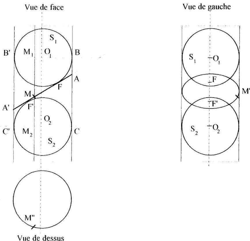
1°) Soit  $M$  un point d'intersection du cylindre (noté  $M$  sur la vue de face,  $M'$  sur la vue de gauche et  $M''$  sur la vue de dessus) et de  $P$ . La génératrice du cylindre qui passe par le point  $M$  coupe  $Q_1$  et  $Q_2$  respectivement en  $M_1$  et  $M_2$ . Démontrer en exploitant les propriétés des tangentes à la sphère ayant un point commun que  $MM_1 = MF$  et  $MM_2 = MF'$  (en vraie grandeur).
