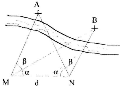
3) Sur la figure ci-contre A et B sont deux points inaccessibles dont on veut mesurer la distance.
