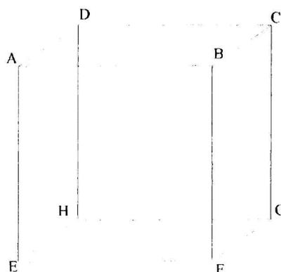
L'écornage du cube a mis en évidence un tétraèdre régulier qui a pour sommets les quatre sommets DBEG du cube et pour arêtes les diagonales DB, DE, DG, EG de faces du cube. L'étude de l'ensemble cube-tétraèdre peut être utilisée pour mettre en évidence des propriétés du tétraèdre régulier ainsi qu'une structure du cube qui n'est pas évidente si l'on considère les deux solides pris séparément.
