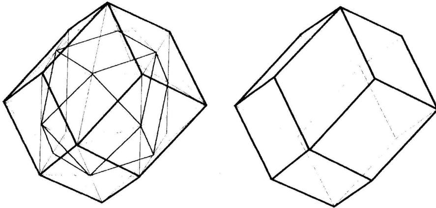
Pour cela, on peut remarquer que le dodécaèdre rhombique peut également s'obtenir en disposant convenablement autour d'un cube les six pyramides à base carrée déterminées à l'intérieur de ce même cube par ses quatre grandes diagonales.
