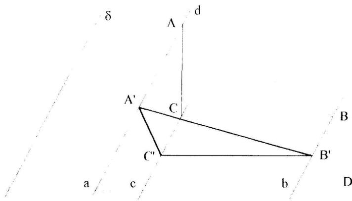
La figure ci-contre représente un triangle  $ABC$  et son image  $A'B'C'$  dans l'affinité définie par la droite  $D$ , la direction  $\delta$  et le nombre  $k = 0,5$ . On a  $\vec{mA'} = 0,5 \vec{mA}$ ,  $\vec{mB'} = 0,5 \vec{mB}$  et  $\vec{mC'} = 0,5 \vec{mC}$ .
