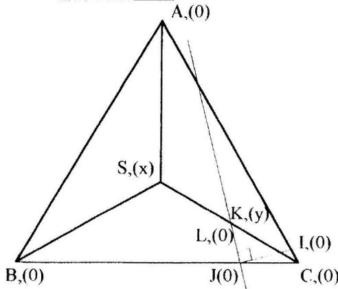
La figure ci-contre est la représentation d'un tétraèdre régulier SABC de 10 cm d'arête, en géométrie cotée ( il s'agit d'une projection orthogonale sur un plan horizontal, chaque point est accompagné d'un nombre qui donne sa hauteur ou cote). Le point K est au milieu de l'arête SC, le point J est sur BC avec  $JC = 2$  cm.
