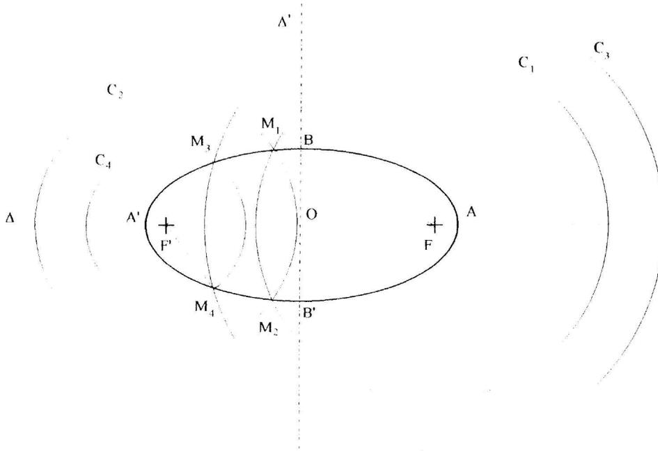
**Conséquences:** L'ellipse a deux axes de symétrie  $\Delta$  et  $\Delta'$  qui se coupent en O, appelé centre de l'ellipse. Les intersections A, A', B, B' de ces axes de symétrie avec l'ellipse sont appelés les **sommets** de l'ellipse. Les distances  $AA' = 2a$  et  $BB' = 2b$  sont appelées **grand et petit diamètre** de l'ellipse. Les droites  $AA'$  et  $BB'$  sont appelées **grand et petit axe** de l'ellipse. On peut remarquer que  $MF + MF' = 2a$ .
