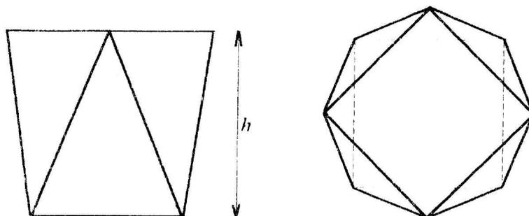
La figure ci-contre représente vu de face et de dessus un polyèdre à 10 faces. Les faces supérieure et inférieure sont des carrés égaux et parallèles qui en vue de dessus ont médianes et diagonales respectives confondues. Les faces latérales sont des triangles isocèles égaux.
