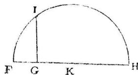
Ou s'il faut tirer la racine quarrée de GH, ie luy adioste en ligne droite FG, qui est l'vnité, & diuisant FH en deux parties esgales au point K, du centre K ie tire le cercle FIH, puis esleuant du point G vne ligne droite iusques à I, à angles droits sur FH, c'est GI la racine cherchée. Ie ne dis rien icy de la racine cubique, ny des autres, à cause que i'en parleray plus commodement cy après.
