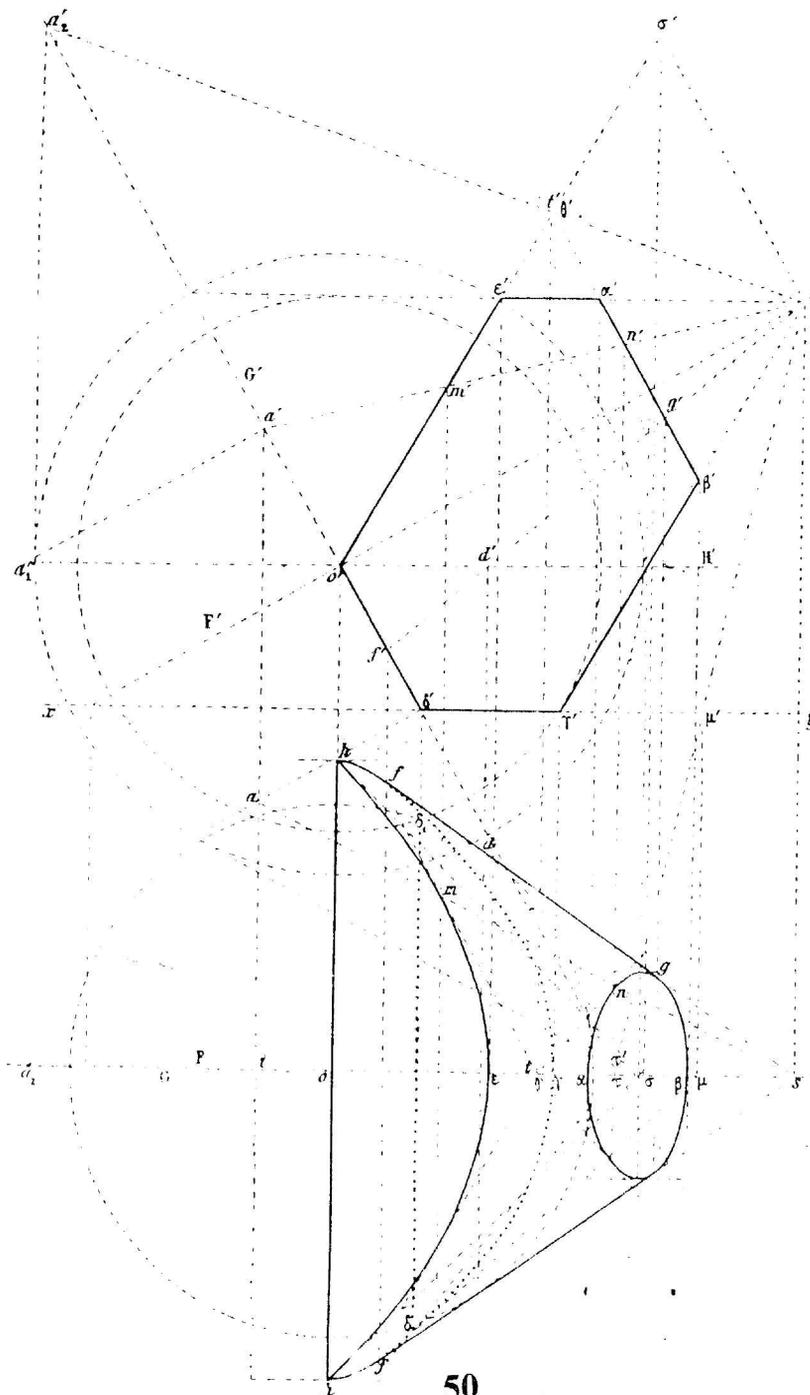
*Remarque.* — On peut opérer beaucoup plus simplement. On sait en effet que le cône et le cylindre projetant horizontalement le cercle  $o$  se coupent suivant deux ellipses, situées par raison de symétrie dans des plans de bout (*Bases de Monge*). On pourrait prendre pour base du cône une de ces ellipses. Les constructions seraient très simples, car cette ellipse se projette horizontalement suivant le cercle  $o$  et verticalement suivant une droite.
