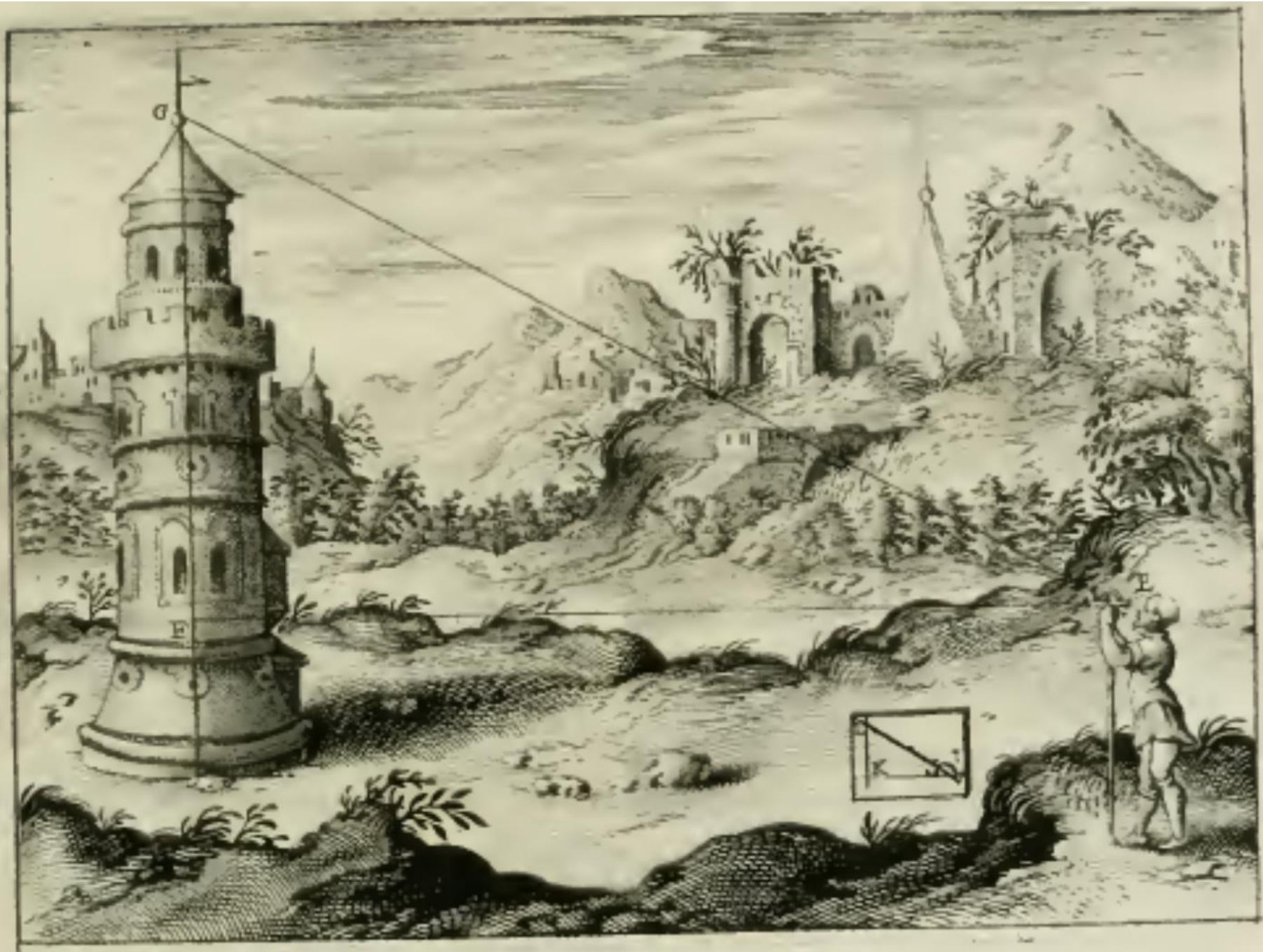
Utilisation du graphomètre pour la mesure de hauteur
