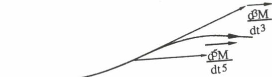
Si  $\frac{d^2\vec{M}}{dt^2} = 0, \frac{d^3\vec{M}}{dt^3} \neq 0, \frac{d^4\vec{M}}{dt^4} = \lambda \frac{d^3\vec{M}}{dt^3}$
