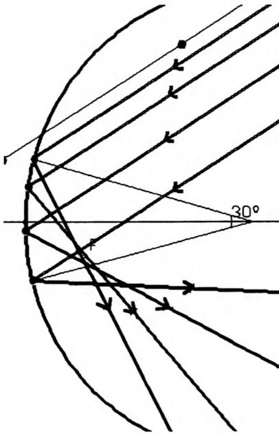
Des rayons lumineux parallèles entre eux ne convergent pour le miroir sphérique que dans les conditions de Gauss, c'est à dire lorsque les rayons sont proches de l'axe optique et peu inclinés par rapport à cet axe.
