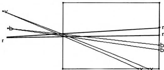
Une chambre noire est une boîte percée d'un trou de diamètre réglable appelé diaphragme.
