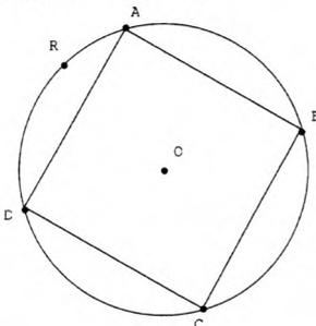
La construction met en évidence qu'un rectangle est fait de deux triangles rectangles symétriques par rapport au centre. On peut remarquer que, pour cette méthode, le rectangle se déforme à diagonales constantes.
