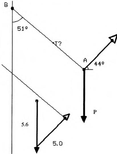
Une petite sphère électrisée est fixée à l'extrémité A d'un fil isolant. L'ensemble est placée dans un champ électrique. L'intensité du champ reste constante mais on peut faire varier sa direction et son sens. La sphère sera donc soumise à une force constante en intensité, mais variable en direction.
