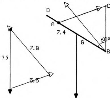
En TP l'élève réalise l'expérience modélisée ci-dessus. Une tige BD homogène, peut tourner autour d'un axe B. Elle est attachée an A par un fil dont l'autre extrémité C est fixe. La tension du fil est mesurée expérimentalement par un dynamomètre. Les élèves pèsent la barre pour déterminer son poids. La modélisation est à l'échelle.
