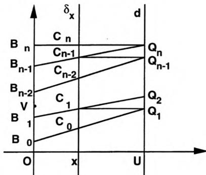
La parallèle à l'axe  $OU$  passant par  $B_n$  coupe  $\delta_x$  et  $d$  aux points  $C_n$  et  $Q_n$  respectivement ; la droite  $B_{n-1}Q_n$  coupe  $\delta_x$  en  $C_{n-1}$  et la parallèle à l'axe  $OU$  passant par  $C_{n-1}$  coupe  $d$  en  $Q_{n-1}$  ; la droite  $B_{n-2}Q_{n-1}$  coupe  $\delta_x$  en  $C_{n-2}$ , et ainsi de suite... La mesure algébrique  $\frac{x C_0}{x C_0}$  est égale<sup>4</sup> à  $P(x)$ .
