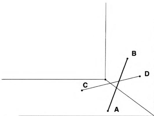
La droite verticale, c'est-à-dire orthogonale au plan du sol issue de I coupe les segments  $[AB]$  et  $[CD]$  respectivement en M et N. Alors le segment  $[AB]$  est au dessus du segment  $[CD]$  si et seulement si N est entre I et M. En classe on peut commenter en remarquant que I est l'ombre au soleil de midi des deux points M et N ...
