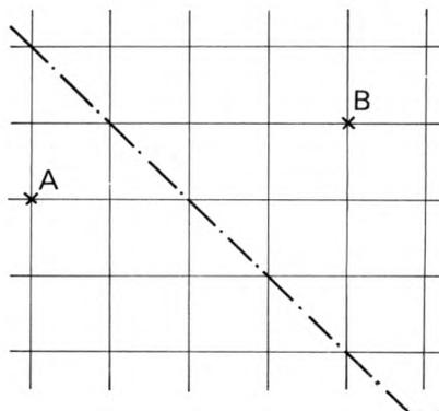
c) *Sur papier blanc, tu utilises, pour construire la trace de pliage, le fait que la droite de pliage est la médiatrice du segment joignant le point et la trace. Dessine A'. A' est sur la perpendiculaire à la droite de pliage qui passe par A. A et A' sont à égale distance de la droite de pliage.*
