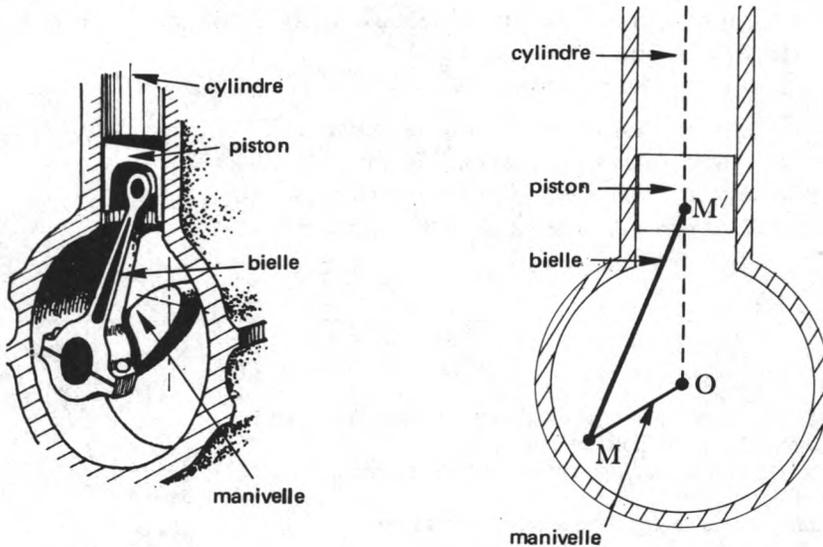
Schématisons le système formé de la bielle  $MM'$  et de la manivelle  $OM$ .
