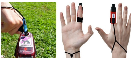
Figure 2 : Balises, doigts électroniques.
