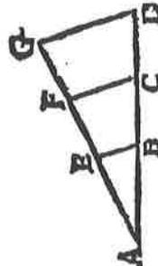
tionnelles à celles de AD. Je joins AG avec AD; de sorte qu'elles aillent un angle, quel qu'il soit. Après je mène par les points G & D une ligne droite, & à celle-ci des parallèles par les points B & C de la coupée. Les parallèles coupent AG, en trois parties, qui sont propor-
