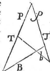
Or afin que les bases soient antiparalleles dans cette disposition, il est clair qu'il faut que les angles que les deux toutes font, l'une sur B & l'autre sur b, soient égaux; Et que ceux que les deux parties font l'une sur B & l'autre sur b soient égaux aussi.
