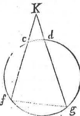
Car (par 31. §.) l'angle  $kcd$  a pour mesure la moitié des deux arcs  $cd$ , &  $cf$ . Or la moitié de ces deux arcs  $cd$  &  $cf$  est aussy la mesure de l'angle  $kcf$ . (par 30. §.) Donc les angles  $kcd$  &  $kcf$  sont égaux.
