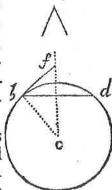
Donc le segment opposé à celui vers lequel est  $fb$  sera capable d'un angle égal à l'angle  $fb d$ , par le 5<sup>e</sup> Corollaire, parce que l'un sera l'angle du segment, & l'autre l'angle dans le segment opposé.
