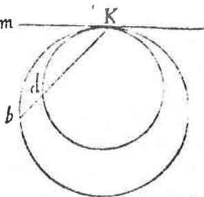
Car les angles  $mkb$  &  $mkd$  sont le même angle. Or l'un a pour mesure la moitié de l'arc  $kb$ , & l'autre la moitié de l'arc  $kd$ . Donc ces deux arcs sont proportionnellement égaux.
